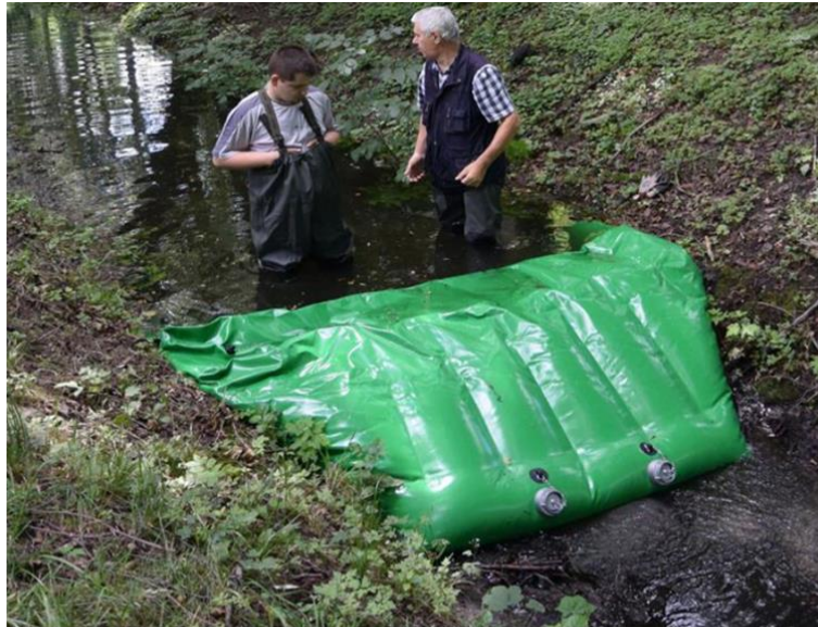
Rysunek 1.1. Przenośny próg piętrzący samoczynnie napelniający się wodą płynącą w rowie; źródło: Zakład Inżynierii i Gospodarki Wodnej ITP – fot. K. Kreżalek [woda.cdr.gov.pl]
